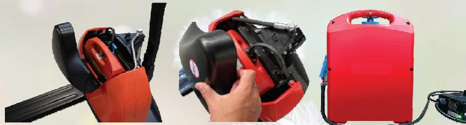
leichte Akkuentnahme, kompakter Lithium-Ionen-Akku (Gewicht 7 kg) mit externem 230 V Ladegerät 15 A
